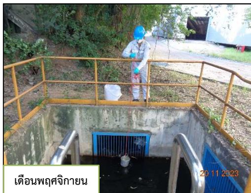
ภาพที่ 3.64 การตรวจวัดคุณภาพน้ำทิ้งบริเวณบ่อพักน้ำทิ้งของโครงการ
